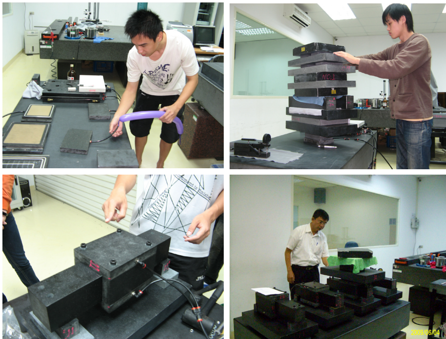
圖八 氣浮軸承以及氣靜壓載台空載與負載情況下之測試情形
