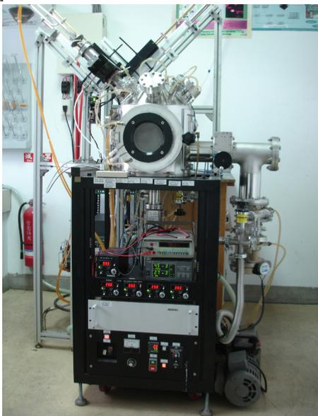
圖四 微波電漿束燒結系統
