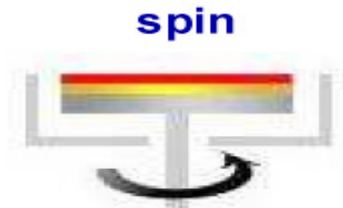
圖8 旋轉塗覆技術示意圖 (資料來源:勝華科技, 2008)
