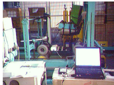
在工廠疲勞測試機上進行實際動態測試
