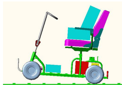
以CAE軟體RecurDyn進行路面疲勞衝擊測試
