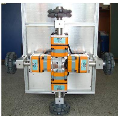
圖二 完成組合的底盤結構
