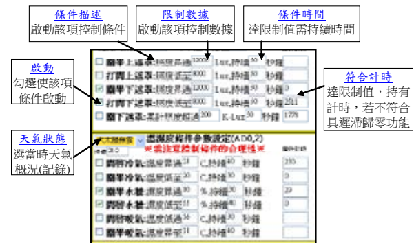
圖5 環控參數邏輯控制畫面
