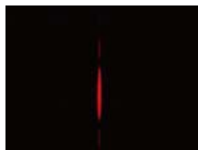
圖十 (c) 縫寬度為0.032mm 之紅光繞射 (三)
