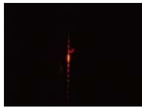
圖十 (a) 縫寬度為0.073mm 之紅光繞射 (一)
