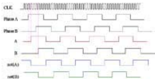
圖八、Encoder 之AB 相波形圖
