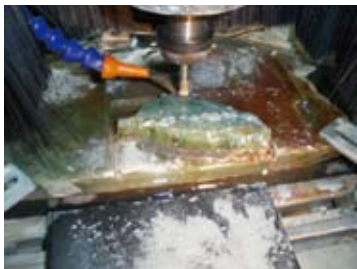
圖9 應用氣浮式振動台對臺灣玉之振動輔助加工
