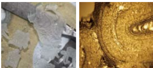
(a) 硬脆材經振動輔助磨削後之 (a) 玻璃樣品與 (b) 磨削後顯微照片(10X)
