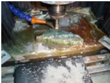
圖8 作為CNC氣浮式高速振動工件載台
