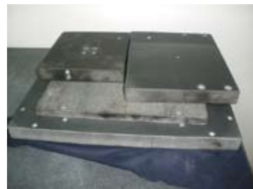
圖7 製作載台所使用之花崗石材氣浮板
