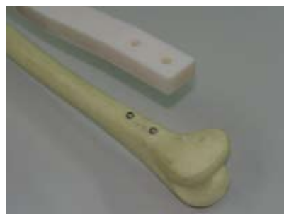
圖十三通用內鎖式骨髓內釘螺鎖導引器模擬使用
