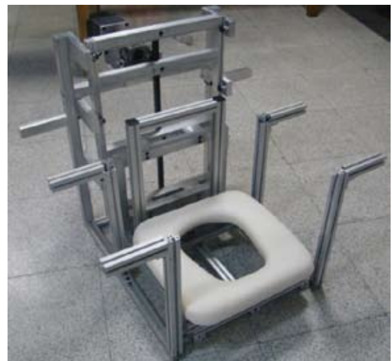
圖十九 升降台下降至浴缸底部
