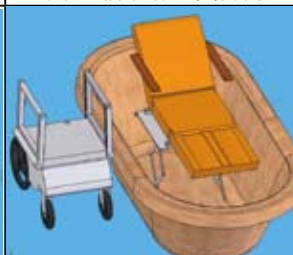
圖八 收回滑軌支撐臂
