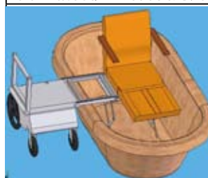
圖七 座椅移至升降台上方
