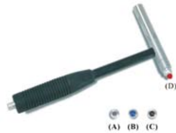
圖8 衝擊錘與錘端照片圖
