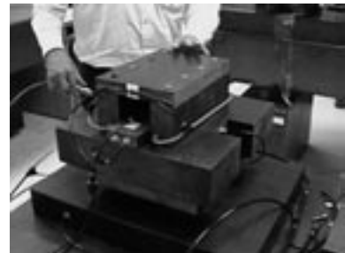
(圖10) 整體花崗岩氣浮XY運動載台組合外觀
