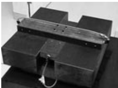
(圖8) 花崗岩床台與十字型氣浮導軌組合圖
