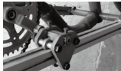
(圖4) 踏步車踏板中的滑塊
