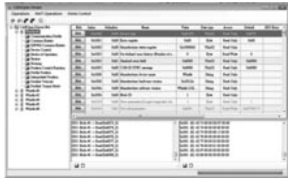
(圖8) 利用SDO，讀取設定機械手臂六個伺服驅動器參數資料
