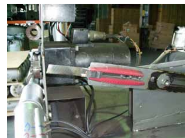
(圖4) 蛇管自動裁切機切刀裁切作動示意圖
