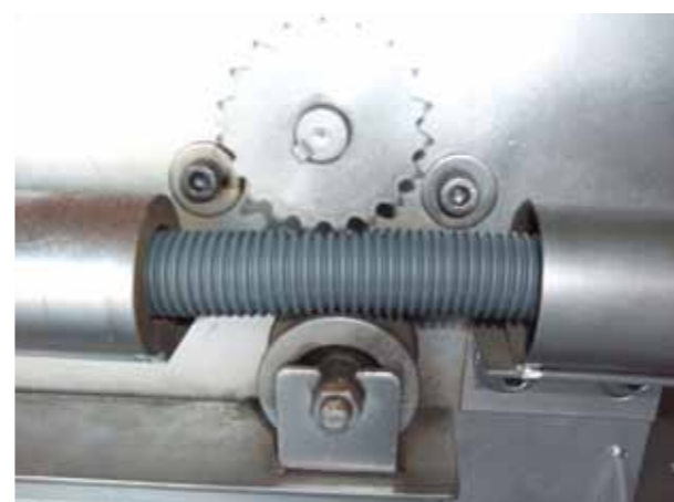
(圖3) 蛇管自動傳動送料示意圖
