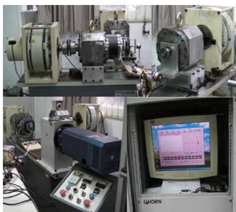
(圖2) 3.0KW電梯齒輪馬達效率測試平台
