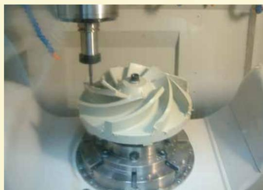
葉輪模型材料之試加工
