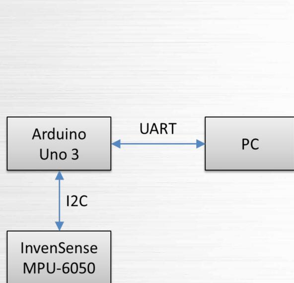
(圖 1) 開發系統架構
