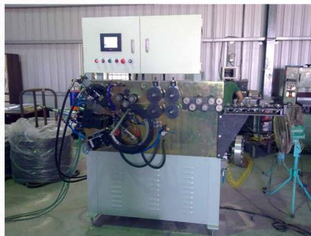
(圖 2) 鐵圈自動成型焊接機
