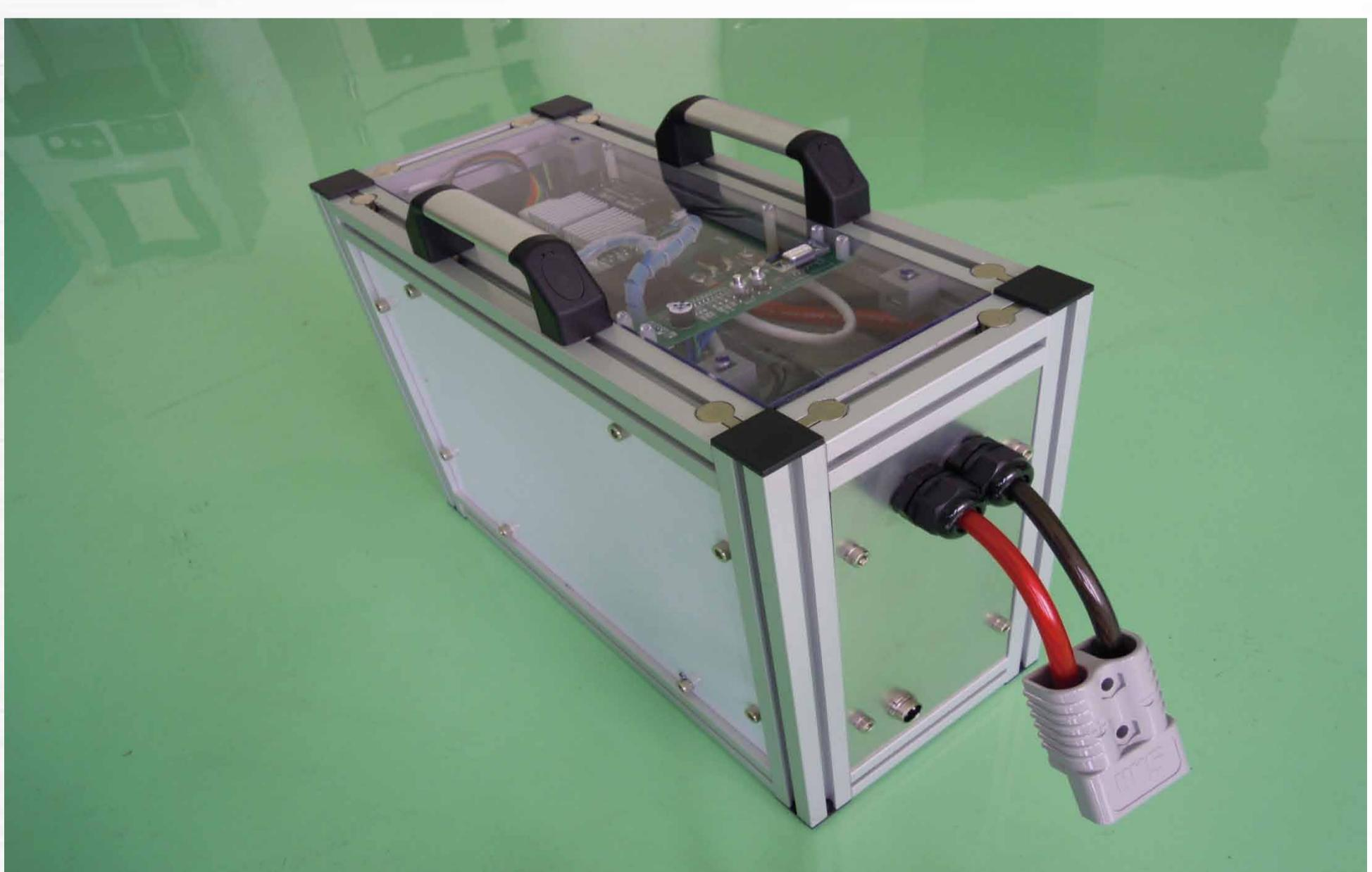
\* 24V/60Ah 可 3C 充電電池模組 (充電電流 180A, 於 15 分鐘充電可達 80%)
