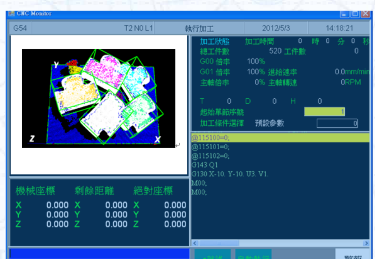
(圖 2) 三維影像與其偵測結果可立即顯示於新代控制器系統之人機介面上
