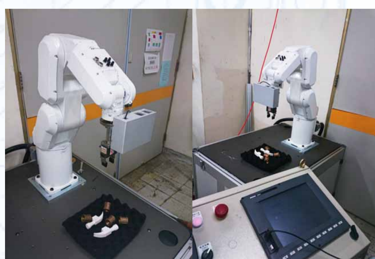
(圖 1) 機械手臂與非接觸式光學探頭整合新代控制器
