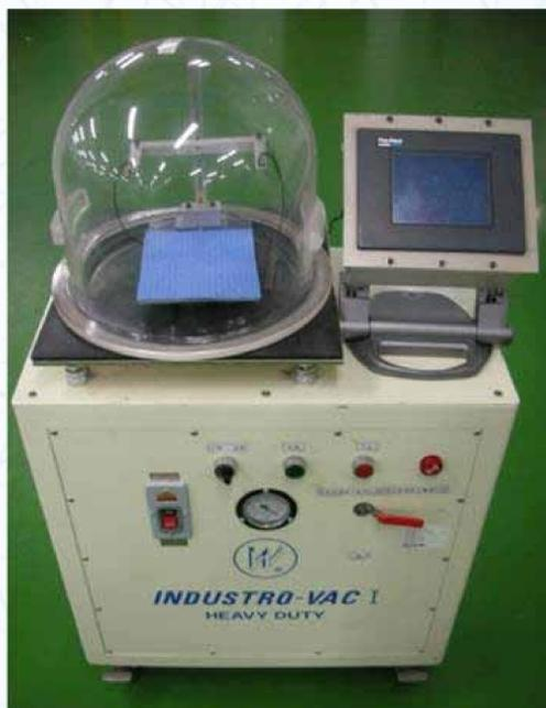
(圖 1) 兼具低成本與高效能之矽膠真空脫泡系統
