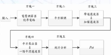
(圖 3) IEC 61000-4-15 電壓閃爍方塊圖
