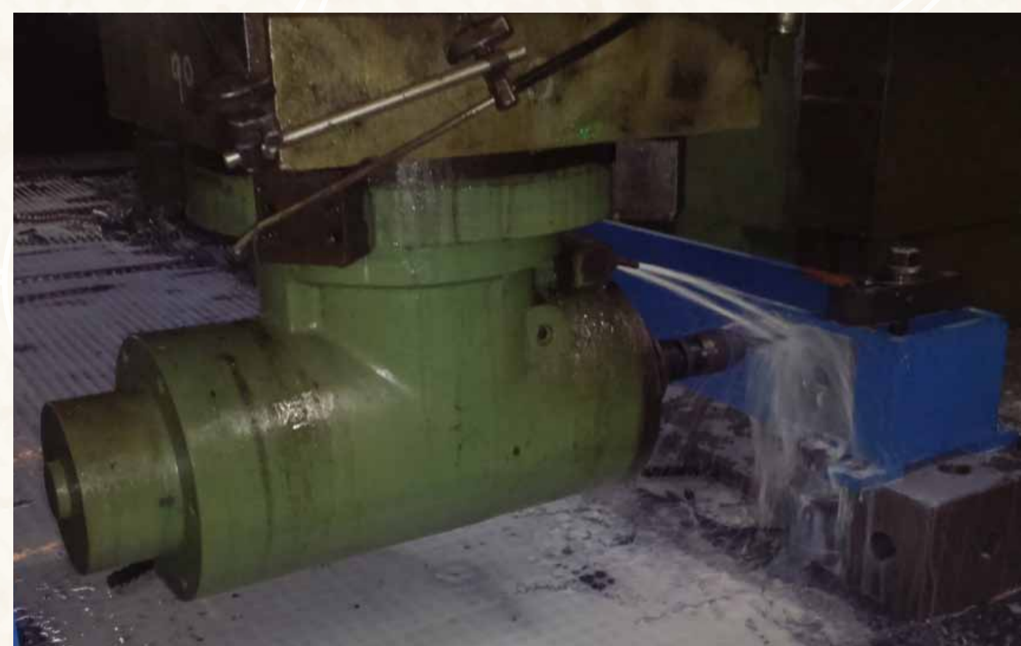
(圖 2) 應用 G212 於工件四周面之孔鑽削技術鑽孔
