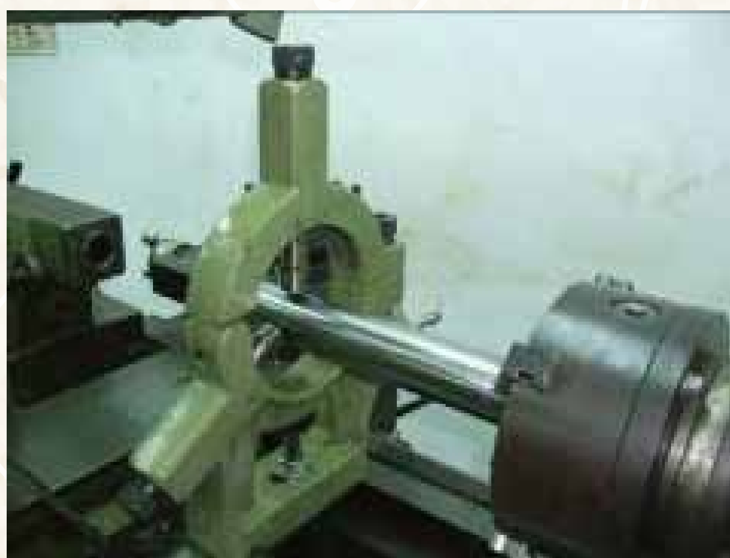
(圖 1) 傳統固定式中心架撐持工件示意圖
