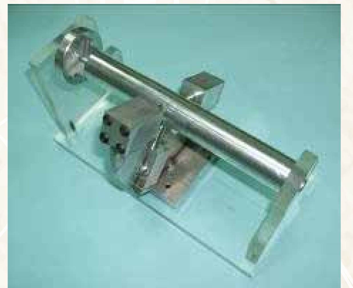
(圖 4) 開放式調整中心扶架教學模型
