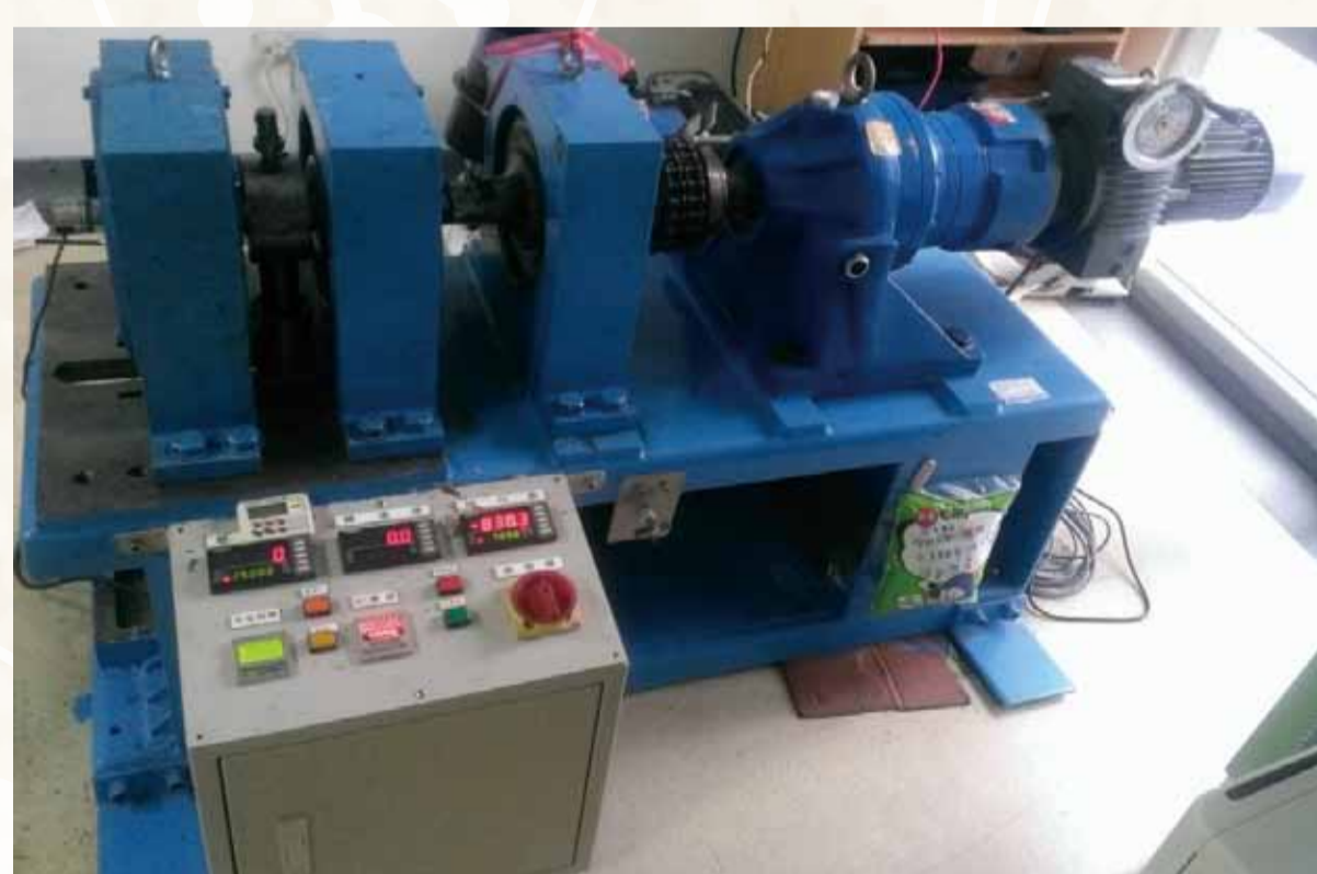
(圖 1) 曲手軸磨耗測試機
