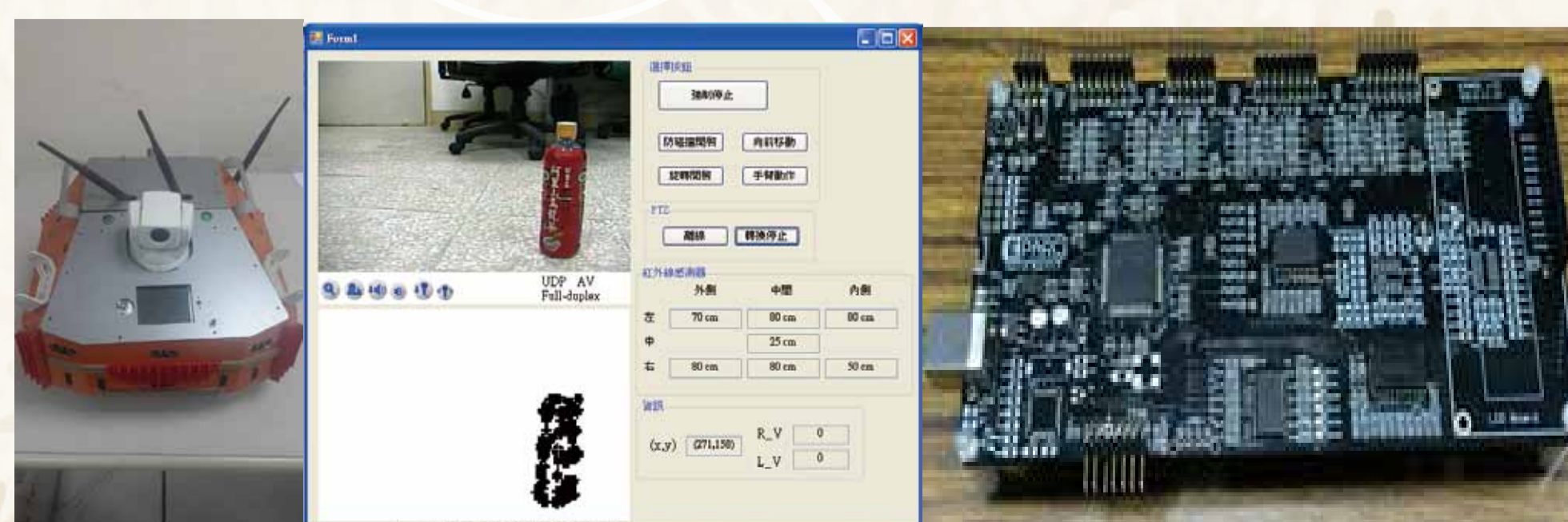
(圖 2) 左側為智慧型機器人、右側為自行開發之網路控制介面與控制電路板
