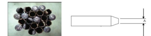
點焊：主要利用高電流方式瞬間將銅管熔接，氬氣為保護銅管使其在高溫時不氧化。
