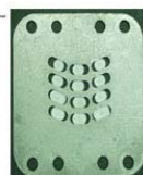
最佳化流道設計 之流動充填情況
