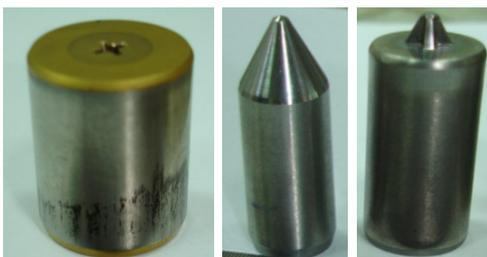
圖7 十字沖頭擠鍛之(a)母模(b)預製胚與鍛件
