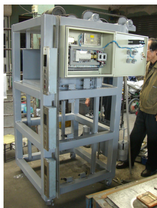
圖6 製作中「負載自動平衡省能源電梯」雛形
