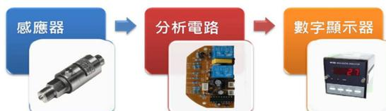
圖七、磅秤系統架構圖
