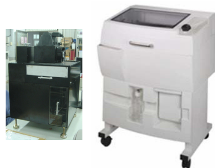
圖8 左圖為自行研發之第四代壓電噴頭立體成型機(機器大小45×44×76cm) 與右圖為 Z Corp 310 3D Printer(機器大小74×81×109cm))
