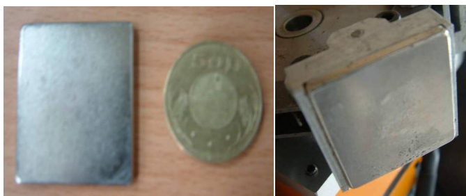
圖三 37mm×32mm厚3mm釹鐵硼磁鐵與導磁框架
