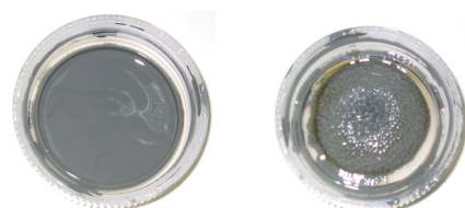
(a)無磁場下 (b)磁場作用下 圖5 磁流變液在無磁場及磁場下的狀態
