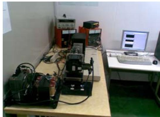
圖七 磁流變液離合器實驗裝置
