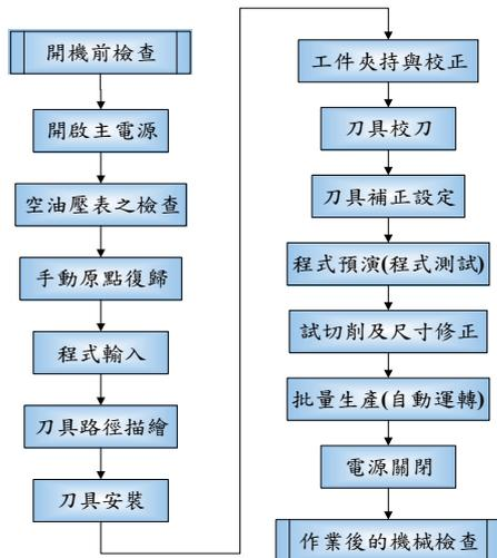
圖二、一般CNC切削中心機上機實作標準操作流程(資料來源：數控工具機原理與實習，陳天生、黃寶建編著)
