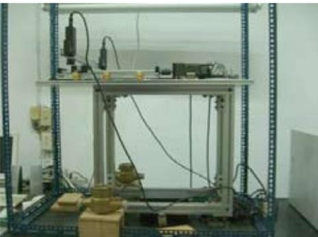
圖3 自動化水錶檢測系統設備正視圖
