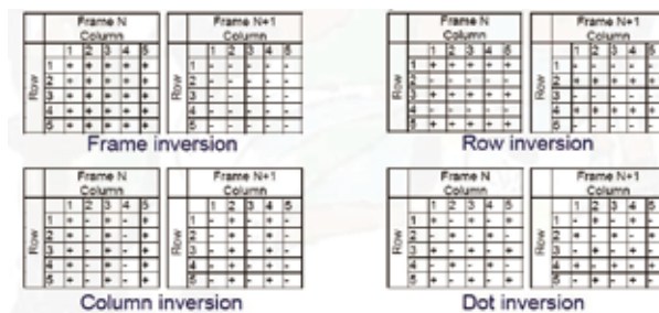
圖3 TFT PANEL各種不同極性的變換方式
