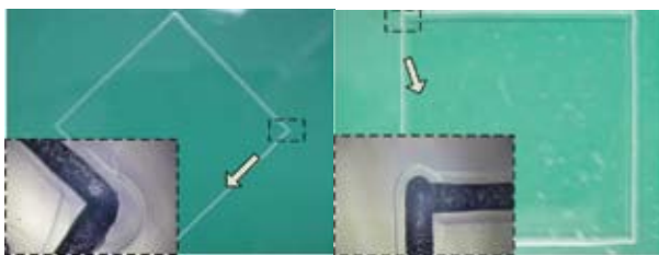
壓克力試片後的情況 圖9自製新式雷射控制器掃描方形及菱形輪廓於 壓克力試片後的情況
