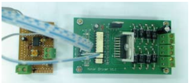
圖5驅動器控制結合PLC實際圖
