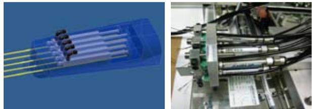
(a)電腦模擬機械手氣壓機構 (b)實際機械手氣壓機構
