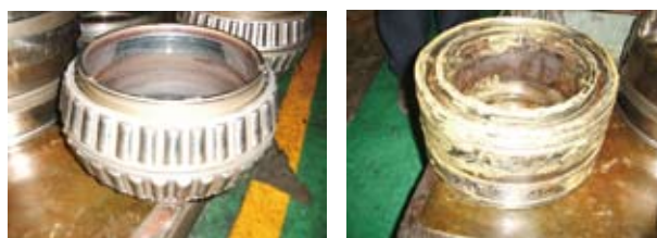
(a) (b) 圖1 軋延滾子軸承(新品) (a)滾子與內環 (b)組立完成並塗抹潤滑脂的滾子軸承
