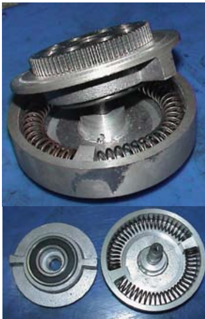
圖6 踩踏儲能裝置的彈簧結構
