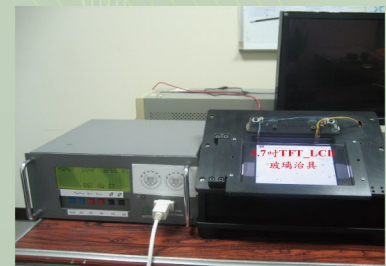
電源驅動訊號產生器本體與承載5.7吋TFT_LCD玻璃活動探針治具
