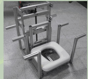
圖四、浴缸升降機構系統之實體結構圖
