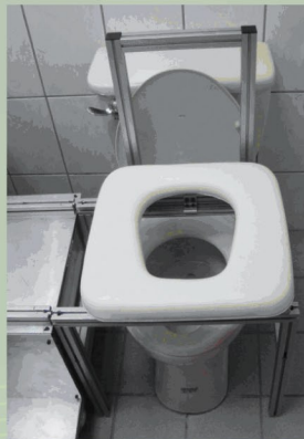
圖二、輪椅移位系統實際應用於馬桶
