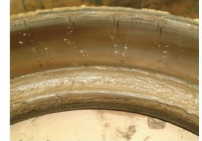
工作30日殘脂與加熱測試色澤比較
