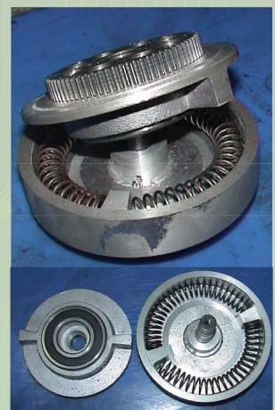
圖四、踩踏儲能裝置的彈簧結構
