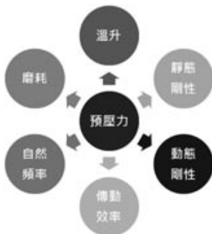
(圖1) 預壓力變化於機台之影響示意圖
